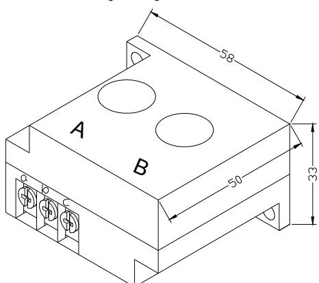
Рисунок 4.1.3. Конструктивные размеры СТ2 (сквозное отверстие диам. 10 мм)
