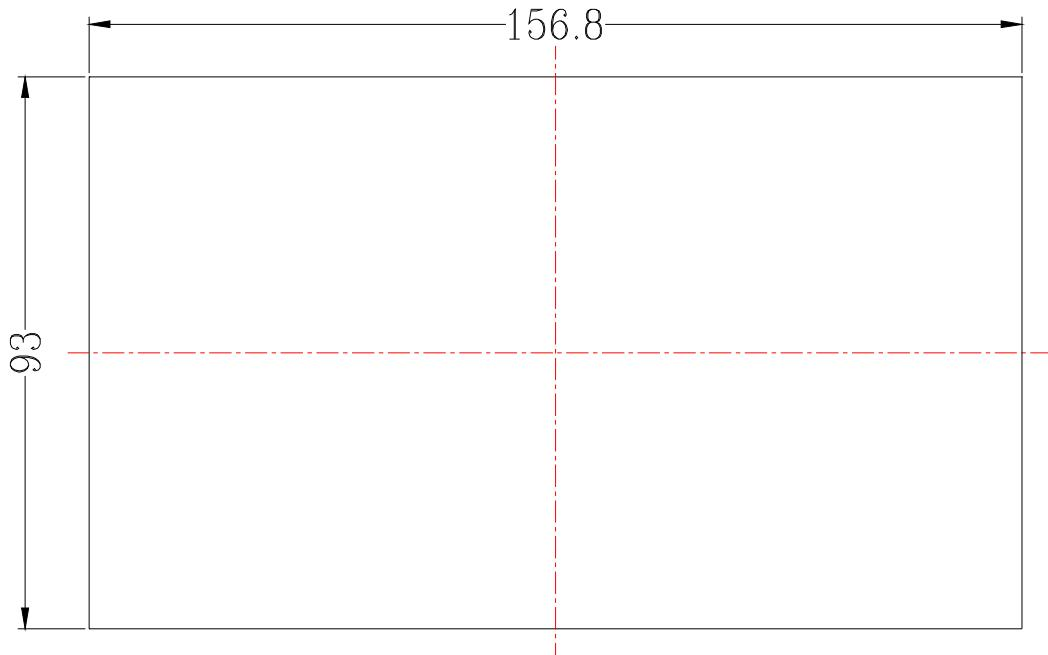
Рисунок 4.1.6. Размеры отверстия
