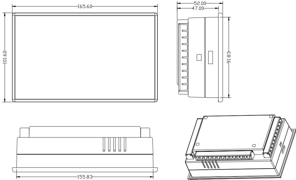
Рисунок 4.1.5. Конструктивные размеры контроллера
