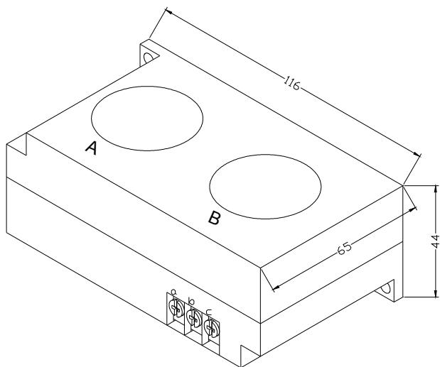
Рисунок 4.1.1. Конструктивные размеры СТ1 (сквозное отверстие диам. 36 мм)
