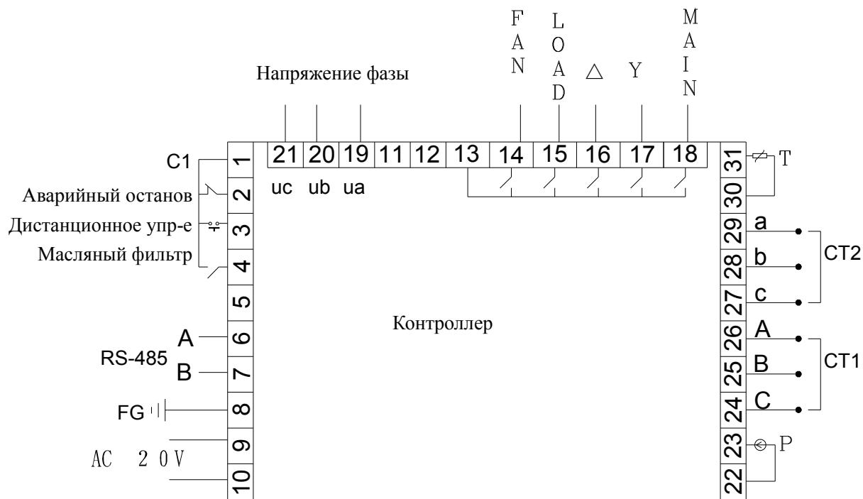
Рисунок 4.2.1. Схема расположения контактов
